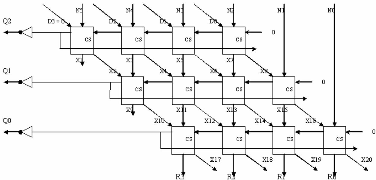
Si evidenzia dalla figura sovrastante come il resto (**borrow**) in uscita della cella elementare più significativa di ogni riga esplicita se la sottrazione dia risultato positivo o negativo (ossia risultato positivo significa  $Divtemp \geq den$ , risultato negativo significa  $Divtemp < den$ ). Inoltre viene inserita una porta *not* in quanto l'algoritmo prevede che il bit di quoziente sia alto quando la sottrazione può essere effettuata (ossia borrow in uscita uguale a zero).
