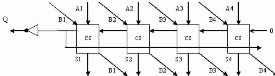
Ovviamente sistemando più strutture riga di questo genere in modo da formare una matrice, otterremo uno schema circuitale che implementa l'algoritmo delle sottrazioni successive:
