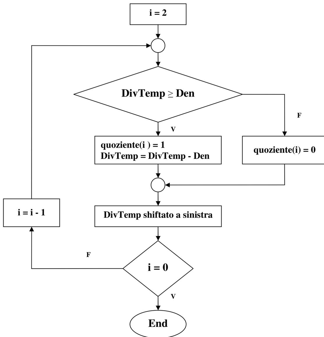
Per poter implementare un algoritmo del genere con una macchina combinatoria abbiamo bisogno di una struttura elementare che ci permetta di effettuare una sottrazione su singoli bit.
